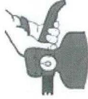
4. Ανακινήστε τον πυροσβεστήρα ή τον σωλήνα εκτόνωσης, με διακοπόμενες επαναλαμβανόμενες κινήσεις προς τα δεξιά και αριστερά, μέχρι να σβήσετε τελείως τη φωτιά.
